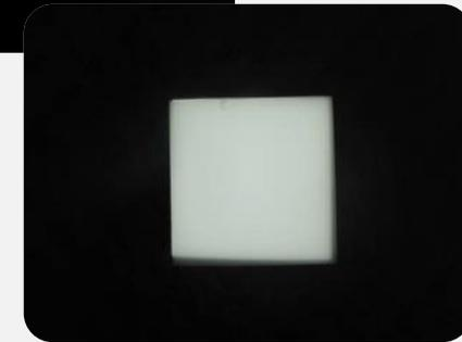
LEDを直下に配置し光の拡散を促し尚且つ光を取出す技術として光が抜ける穴を無数に空ける。これにより、点光源がいくつもできるようなイメージになり、面光源としての発光を行う。サイドエッジ型のシボ面と正反対な技術になります。
